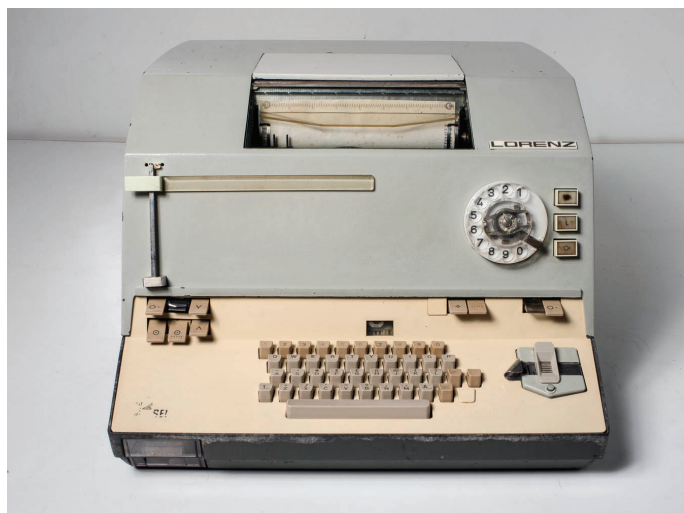
Aparelho das décadas de 1960 e 1970 para enviar e receber telegramas: as máquinas de Telex só seriam aposentadas no começo dos anos 2000, com a popularização da internet
